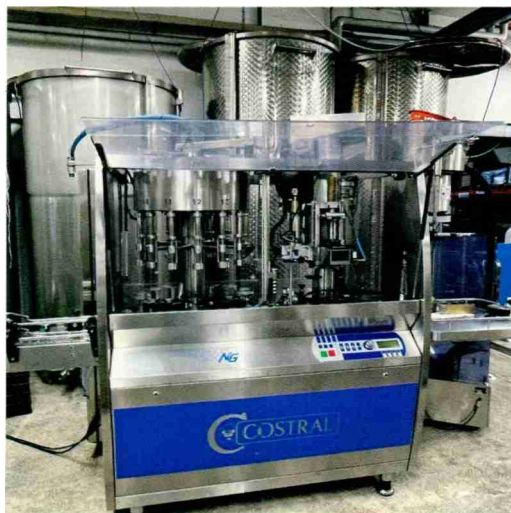
Une machine mobile à embouteiller qui permet d'aller travailler directement chez le vigneron.
